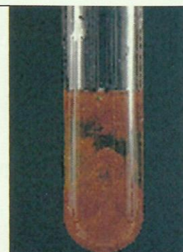
Doc. 4 La précipitation de l'hydroxyde de fer (III) permet la mise en évidence des ions fer (III).
